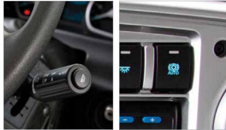
مقبض تشغيل فرملة المحرك ومكبّح "إنتاردر" Intarder: يمكنك تفعيل الفرامل المساعدة يدوياً، أو يمكنك السماح للمركبة بالتحكم بها تلقائياً.
